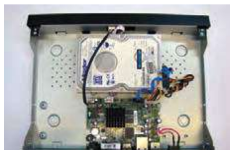
شکل ۳۵- محکم کردن دیسک سخت در محل نصب
