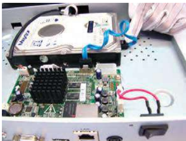
شکل ۳۳- اتصال کابل داده دیسک سخت
