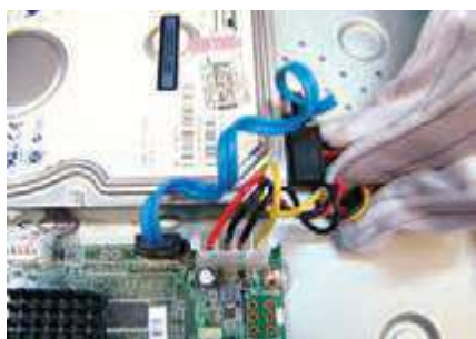
شکل ۳۴- اتصال کابل تغذیه دیسک سخت
