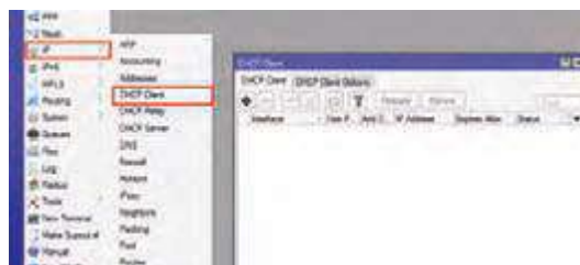
شکل ۳۰- پنجره تنظیمات DHCP Client
