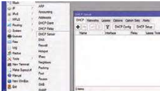
شکل ۳۲- مسیر دسترسی به تنظیمات DHCP Server
