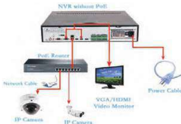
شکل ۱۷- اتصال دوربین به NVR
