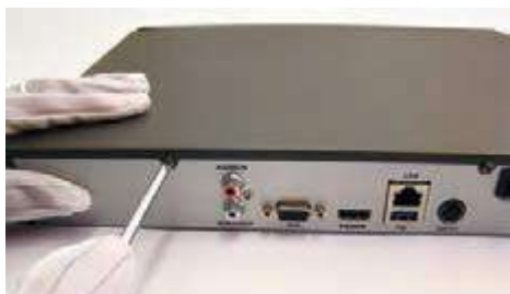
شکل ۳۲- باز کردن درپوش NVR
