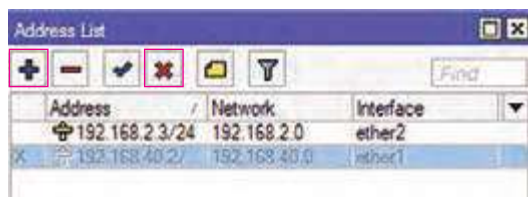
شکل ۲۹- غیرفعال کردن آدرس IP روی ether1
