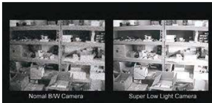
شکل ۱۸- تأثیر مشخصه Minimum Illumination در تصویر
