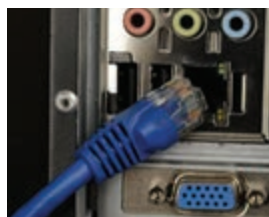
شکل ۵۵-۱ درگاه شبکه و کابل مربوطه
