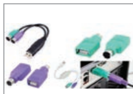
شکل ۱-۵۶- مبدل PS/2 به USB و برعکس
