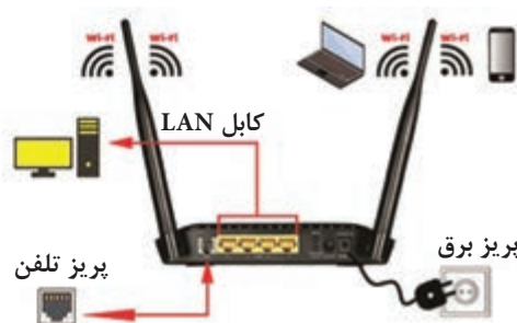
شکل ۳-۱۰- نمای روبه‌رو و پشت مودم ADSL دو آنتن
