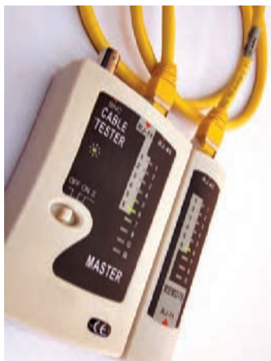
شکل ۲۰- تست کابل شبکه
