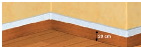
شکل ۵۲ - فاصله داکت یا ترانک از کف
