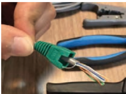
شکل ۲۶- وارد کردن کاور سوکت سر کابل
