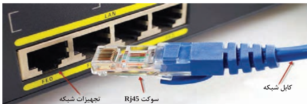
شکل ۶- اتصال سوکت Rj45 به تجهیزات شبکه
