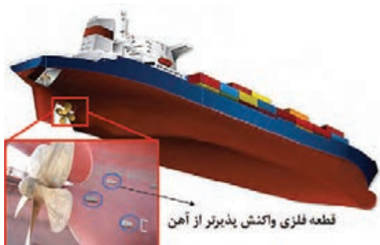
شکل ۱۲. چگونگی حفاظت کاتدی بدنه کشتی
