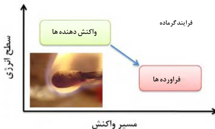
شکل ۷. سطح انرژی واکنش دهنده‌ها و فراورده‌ها در یک فرایند گرماده
